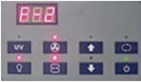
Pantalla LED. Nivel de flujo de aire
