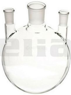
Balón x 3000 ml de 3 bocas paralelas Central 24/50, Laterales 24/40. Marca IVA, modelo 200316
