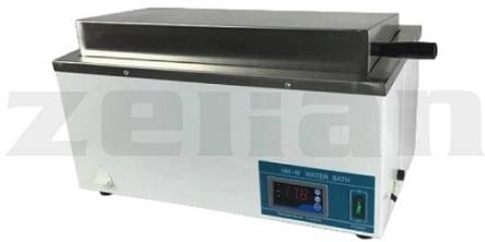
Baño termostático digital con tapa de 32 lts. Marca Numak, modelo HH-W600
