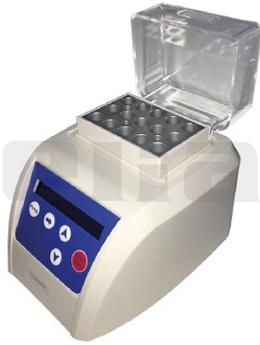
Baño de Bloque Seco de alta precisión programable. Marca Numak, modelo MiniZ. Presenta un display LED que muestra temperatura y tiempo. Es muy fácil de limpiar y desinfectar.
