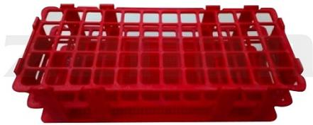
Gradilla plástica para 60 tubos de ensayo. Marca Numak
